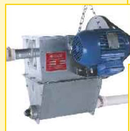
Moega Intermediária acionamento polia e correia ou moto-redutor
